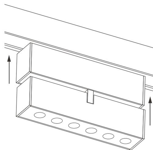
Рис. 2. Установка светильника
