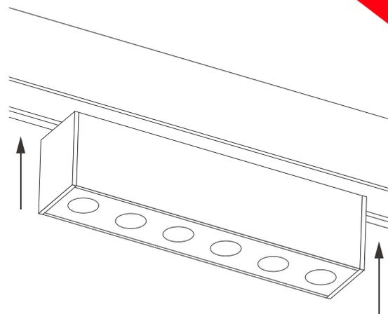
Рис. 2. Установка светильника
